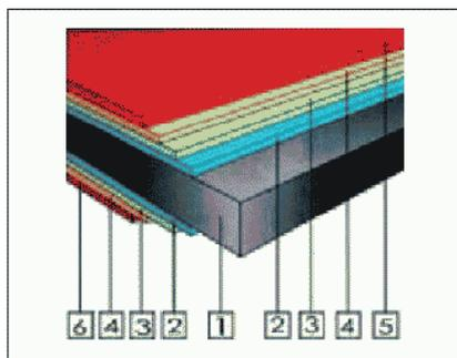
Устройство фальцевых кровель материалами: сталью с оцинкованной или с покрытием (полиэстер, пластизол, пурал):
