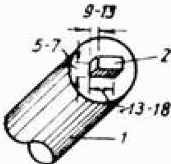
Рис. 18. Шип для насадки нижнего венца или обвязки:
