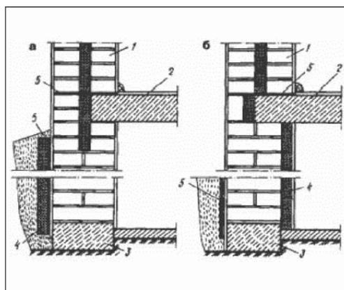
Утепление стен подвала следующими материалами: негоряемая каменная вата, экструдированный пенополистирол и др. современными материалами (рис. 10).
